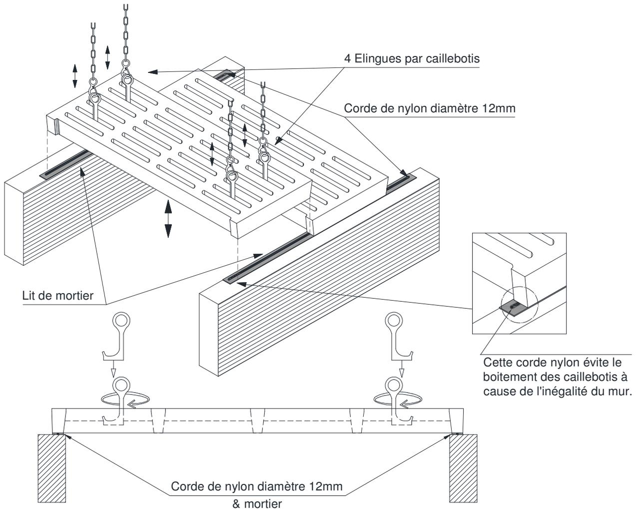
Quatre chaînes doivent être attachées aux élingues de levage pour soulever ces éléments en béton. C'est recommandé de tirer les chaînes verticalement vers le haut et non en diagonale l'une vers l'autre afin de ne pas endommager les éléments en béton.
