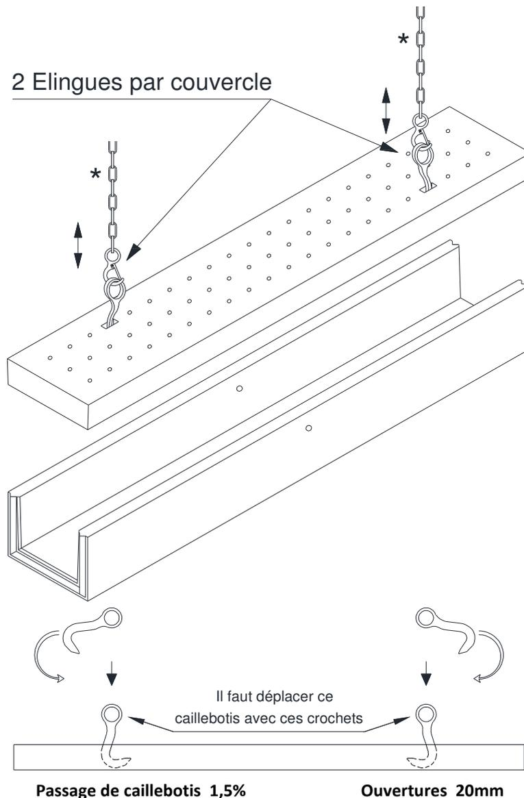
Deux chaînes doivent être attachées aux élingues de levage pour soulever ces éléments en béton. C'est recommandé de tirer les chaînes verticalement vers le haut et non en diagonale l'une vers l'autre afin de ne pas endommager les éléments en béton.
