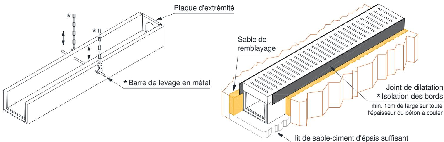
Deux chaînes doivent être attachées aux barre de levage pour soulever ces éléments en béton. C'est recommandé de tirer les chaînes verticalement vers le haut et non en diagonale l'une vers l'autre afin de ne pas endommager les éléments en béton.
