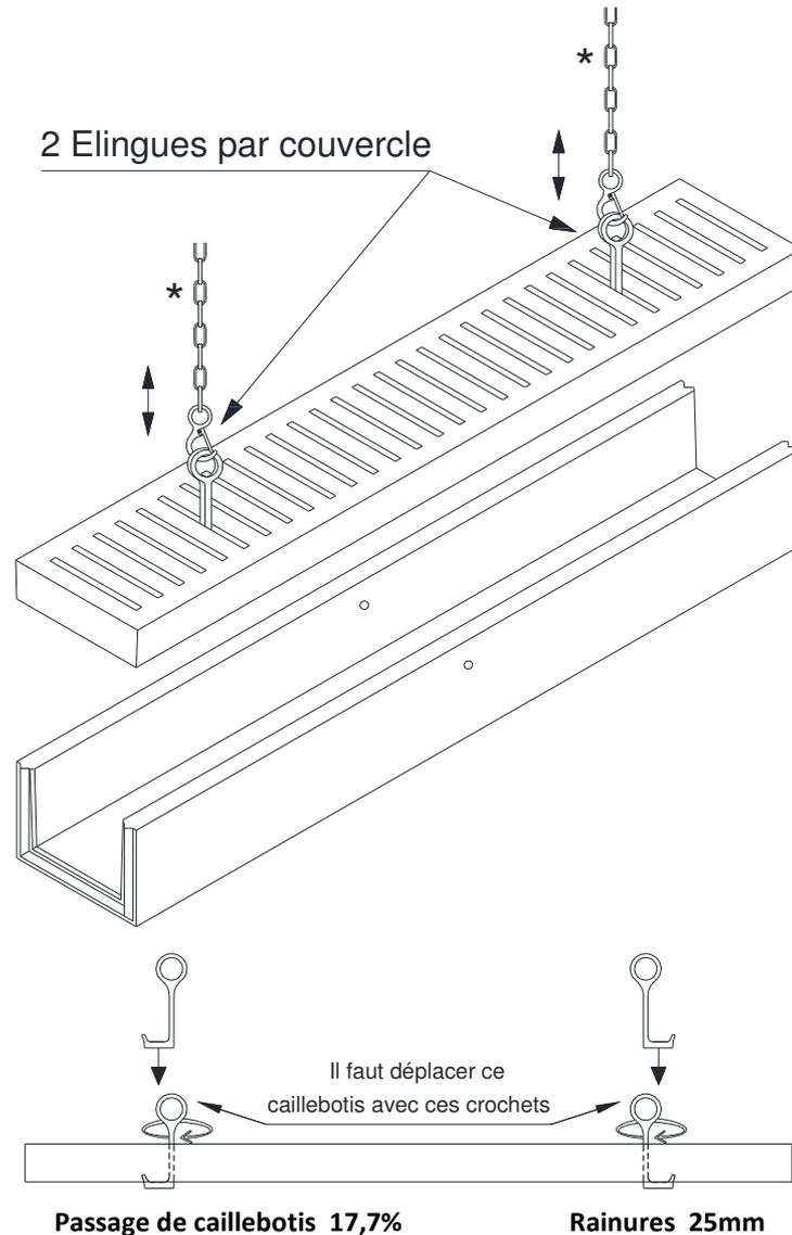
Deux chaînes doivent être attachées aux élingues de levage pour soulever ces éléments en béton. C'est recommandé de tirer les chaînes verticalement vers le haut et non en diagonale l'une vers l'autre afin de ne pas endommager les éléments en béton.
