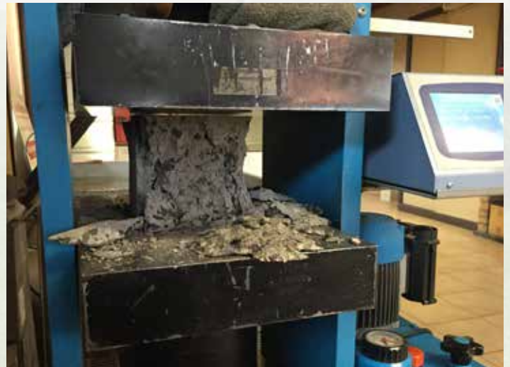
Dagelijkse controle van de druksterkte van het beton.
